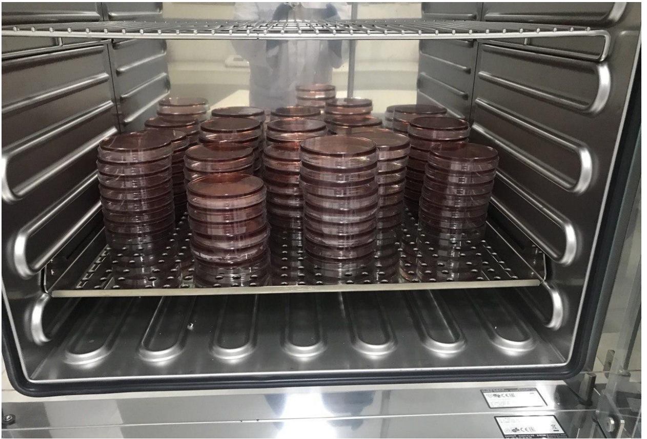
រូបភាពទី៥ សំណាកត្រូវបានដាក់បណ្តុះក្នុងឡ Incubator រយៈពេល២៤ម៉ោង សីតុណ្ហភាព ៣៥ អង្សាសេ
