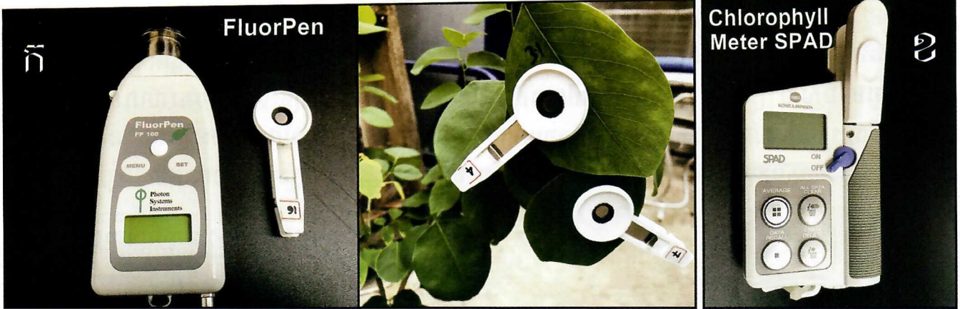
រូបភាពទី ១: រូប(ក) ឧបករណ៍វាស់វែងការសាយភាយពន្លឺ (FluorPen) និង រូប(ខ) ឧបករណ៍វាស់វែងកម្រិតបៃតងក្នុងស្លឹក (Chlorophyll Meter SPAD)
