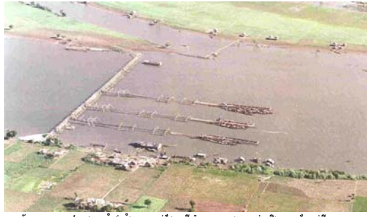
ទូកឆេសាមលេខ ៩ ក្នុងខេត្តកំពង់ឆ្នាំង ។ ឆ្នស់ដែលប្រើប្រាស់ ៣ បន្ទុយដោយឆ្នស់ និង មានប្រព័ន្ធចម្រើក្រោយ ។ (Fishing lot No. 9 in Kampong Chhnang. Barrage with 3 yors, sorting platforms and pens.)
