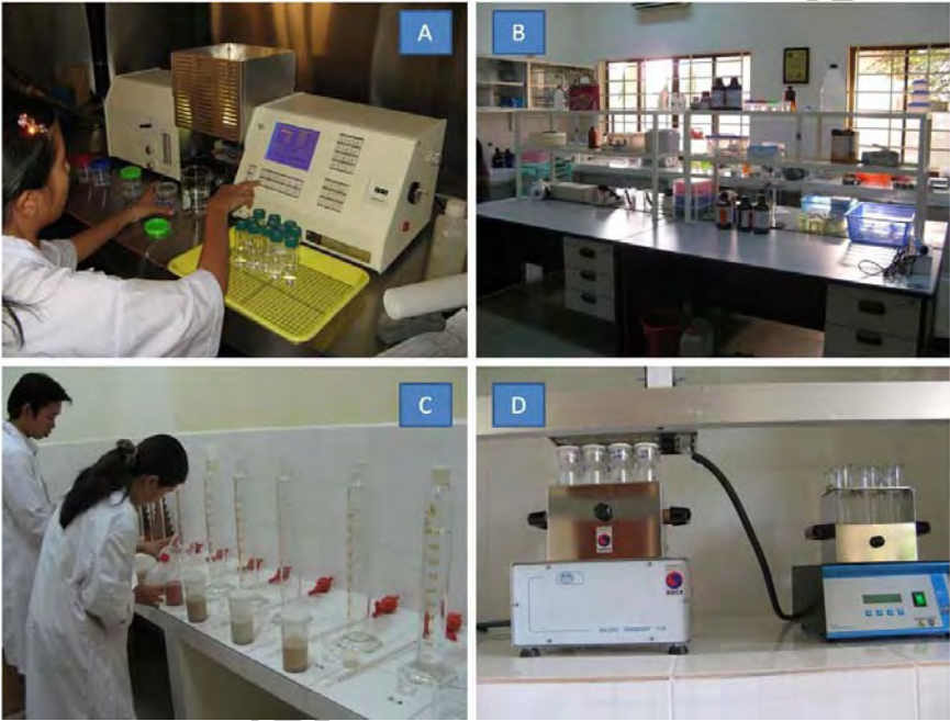
រូបភាពទី១៦: ទិដ្ឋភាពក្នុងមន្ទីរពិសោធន៍របស់ការិយាល័យវិទ្យាសាស្ត្រដី និងទឹក។ (A) ឧបករណ៍ AAS, (B) បន្ទប់វិភាគដី, (C) បន្ទប់វិភាគវាយនភាពដី, (D) ឧបករណ៍ដុតរំលាយសំណាកដោយកំដៅខ្ពស់។
