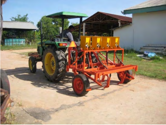
រូបភាពទី៩- ម៉ាស៊ីនដាំគ្រាប់ធញ្ញជាតិ បំពាក់ជាមួយត្រាក់ទ័រ។
