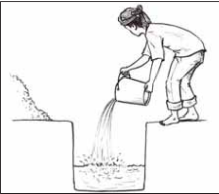
ក. ដឹករណ្តៅជម្រៅ ១ម៉ែត្រ ចាក់ទឹកឱ្យពេញក្នុងរណ្តៅ
