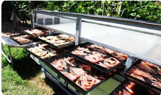
ការហាលសម្ងាត់ត្រី ដោយឧបករណ៍ហាលសម្ងាត់ ប្រើថាមពលព្រះអាទិត្យ
