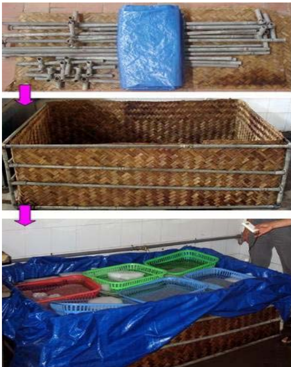
ឧបករណ៍បញ្ចុះសីតុណ្ហភាពដោយទឹកសម្រាប់ព្រីខូលីងបន្ត និងផ្លែឈើ បង្កើតនៅ FAVRI, វៀតណាម និងការប្រឹងប្រែងកាត់បន្ថយរបួសប៉េងប៉ោះ (ចំណុចពណ៌ត្នោត) ក្នុងការស្តុកទុកនៅ ១០°C ។
