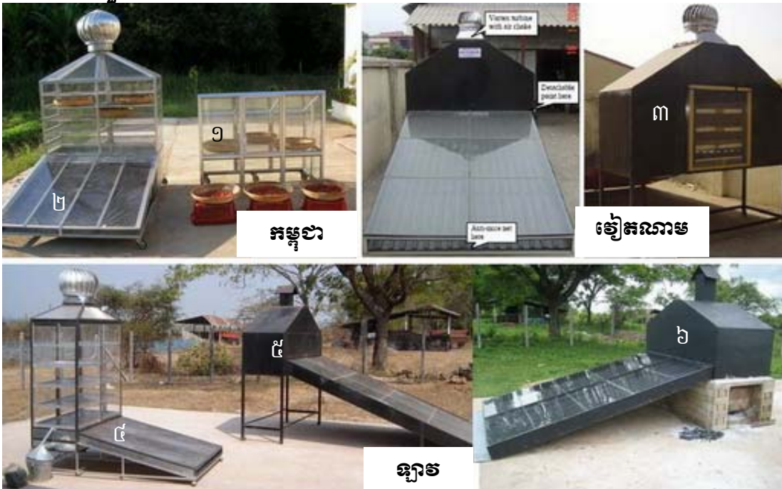
ម៉ាស៊ីនសម្ងាត់ប្រភេទជាទូទៅ (១) ម៉ាស៊ីនសម្ងាត់ជាមួយបន្ទះស្រូបពន្លឺ និងបន្ទប់សម្ងាត់ធ្វើពីបន្ទះញាស្ទឹក (២, ៤) ឬកញ្ចក់ និងបន្ទះសង្កសី (៣, ៥, ៦) ព្រមជាមួយបន្ទប់កំដៅសម្រាប់សម្ងាត់នៅពេលភ្លៀងរមយស្រទុំ (៦)។
