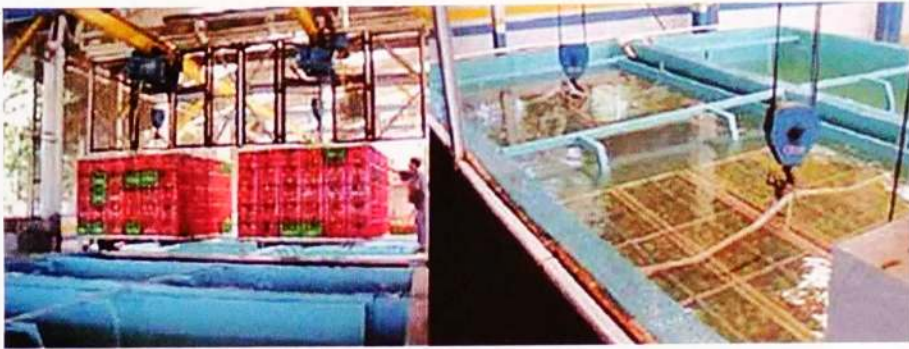
រូបភាព VII.2.4 ឧបករណ៍ប្រព្រឹត្តកម្មទឹកក្តៅលក្ខណៈពាណិជ្ជកម្មសំរាប់ផ្លែស្វាយ
