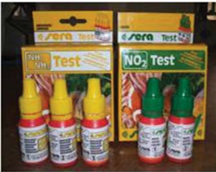
រូបភាពទី៥: ឧបករណ៍វាស់អាម៉ូញាក់ និងនីត្រីក
