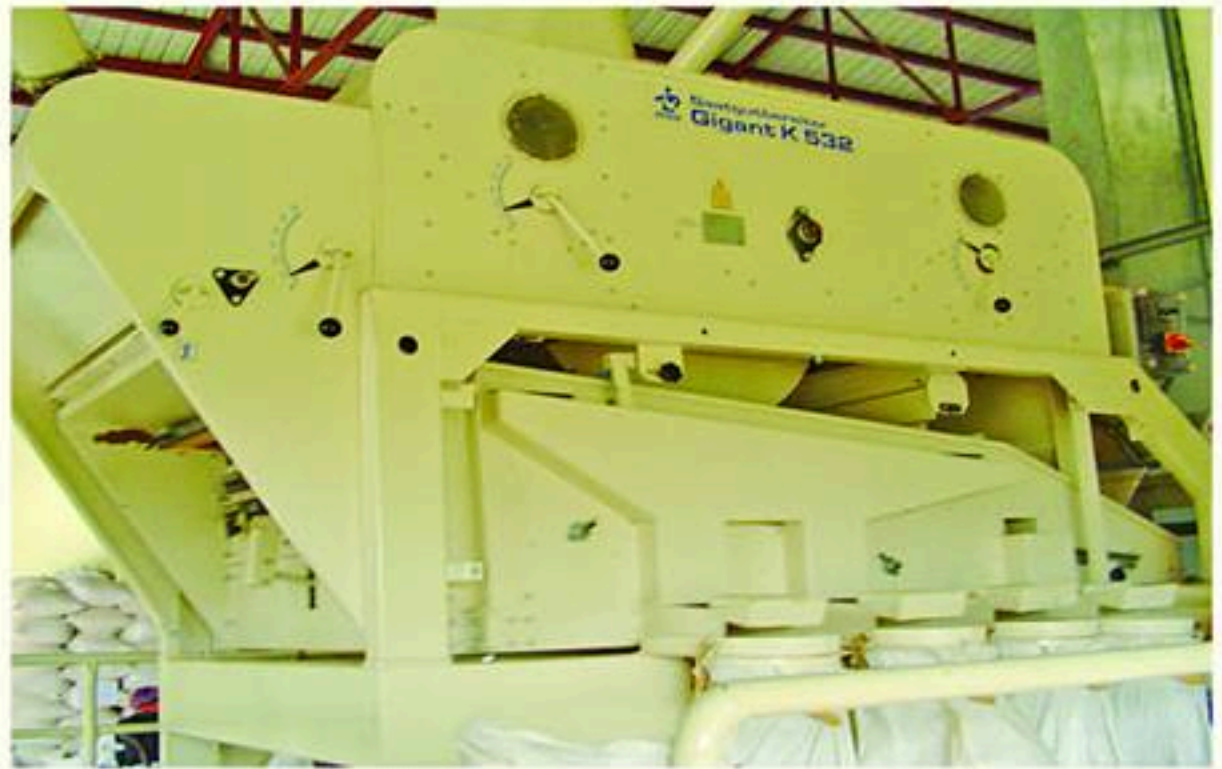
រូបទី១៨ ៖ ឧបករណ៍រោយគ្រាប់ស្រូវបែបមេកានិក
