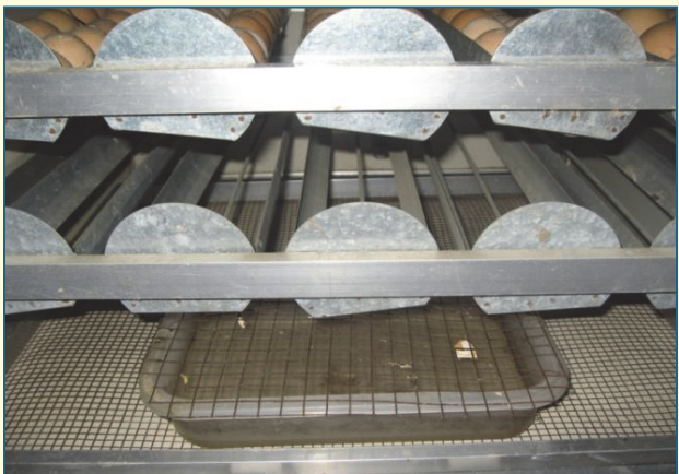
រូបទី២១ ដាក់ថាសទឹកពីក្រោមសម្រាប់រក្សាសំណើម
