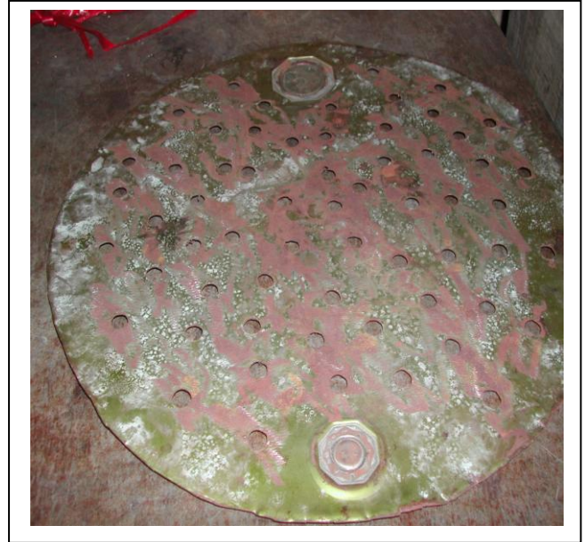
ចាន់តំរបធុងសាំងធ្វើឡាំងស៊ីងសម្រាប់ចំហុយកំប៉ុស្តិ៍អាចម៍រណារ
