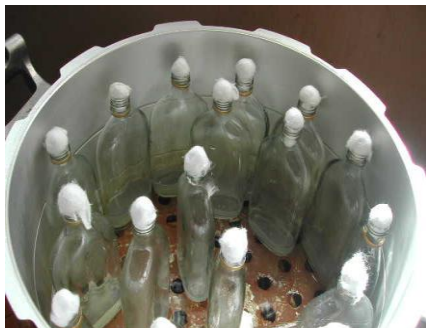
ការតំរៀបដបល្លាយសារាយក្នុងឆ្នាំងអូតូក្លាវ
