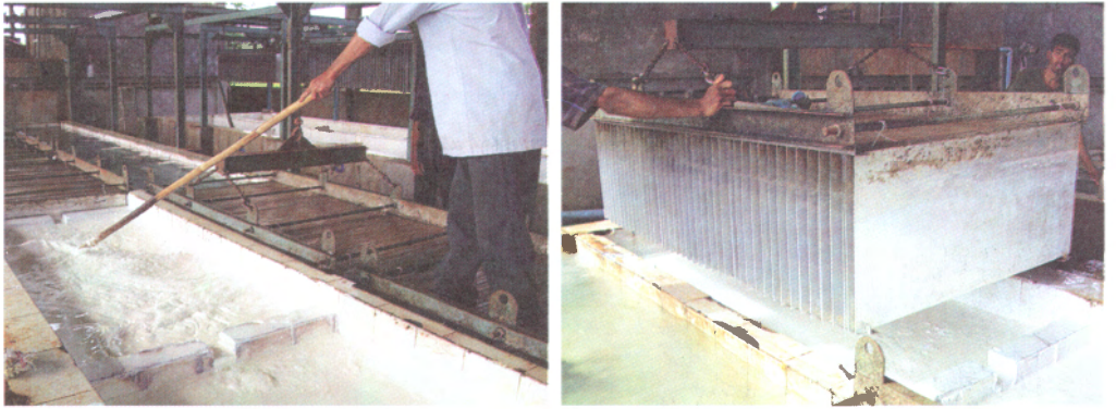
ការកូរលាយអាស៊ីត និង ការទម្លាក់សាងបន្ទះអាលុយមីញ៉ូម
