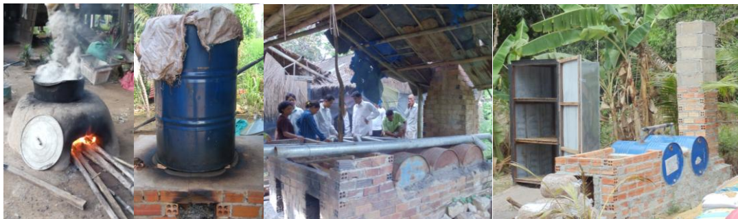
រូបលេខ ៤: ប្រភេទចង្ក្រាន ប្រើសម្រាប់ចំហុយល្បាយបណ្តុះផ្សិតចំបើង
