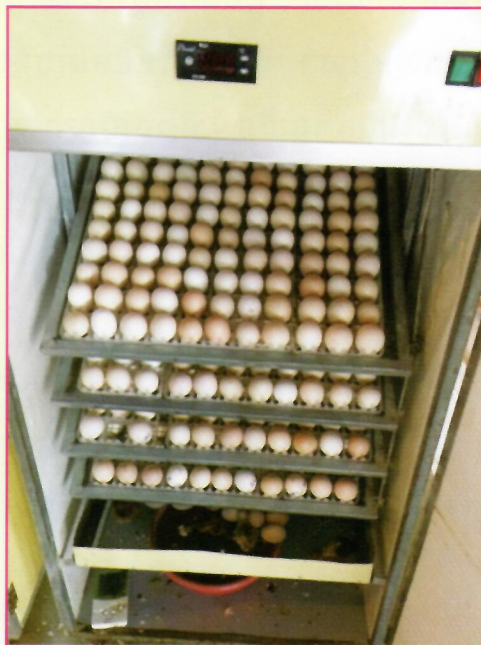
រូបទី១៨: ទូភ្នាស់មាន៤ធ្មើរ ១ធ្មើរដាក់ស៊ុតបាន១៥៦ត្រាប់ ប្រអាចភ្នាស់កូន បាន១៥៦កូន/សា (សប្តាហ៍)
